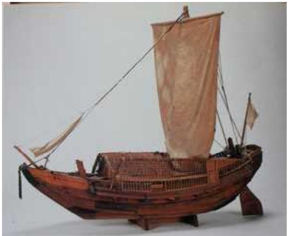
また、航と棚板の厚さを増して、船体の強度と耐久性を大幅に改善し、二の間上部を水密の甲板張り、その下の部屋には網・道具類を収容し、積荷のあるときには伝馬をこの上に置いた。
